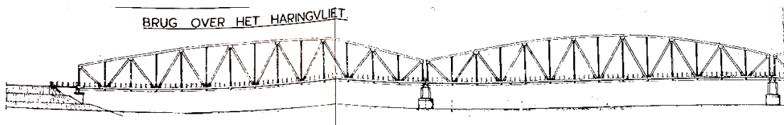
Afbeelding 9 Brug type 1 met traditionele stalen opbouw.
