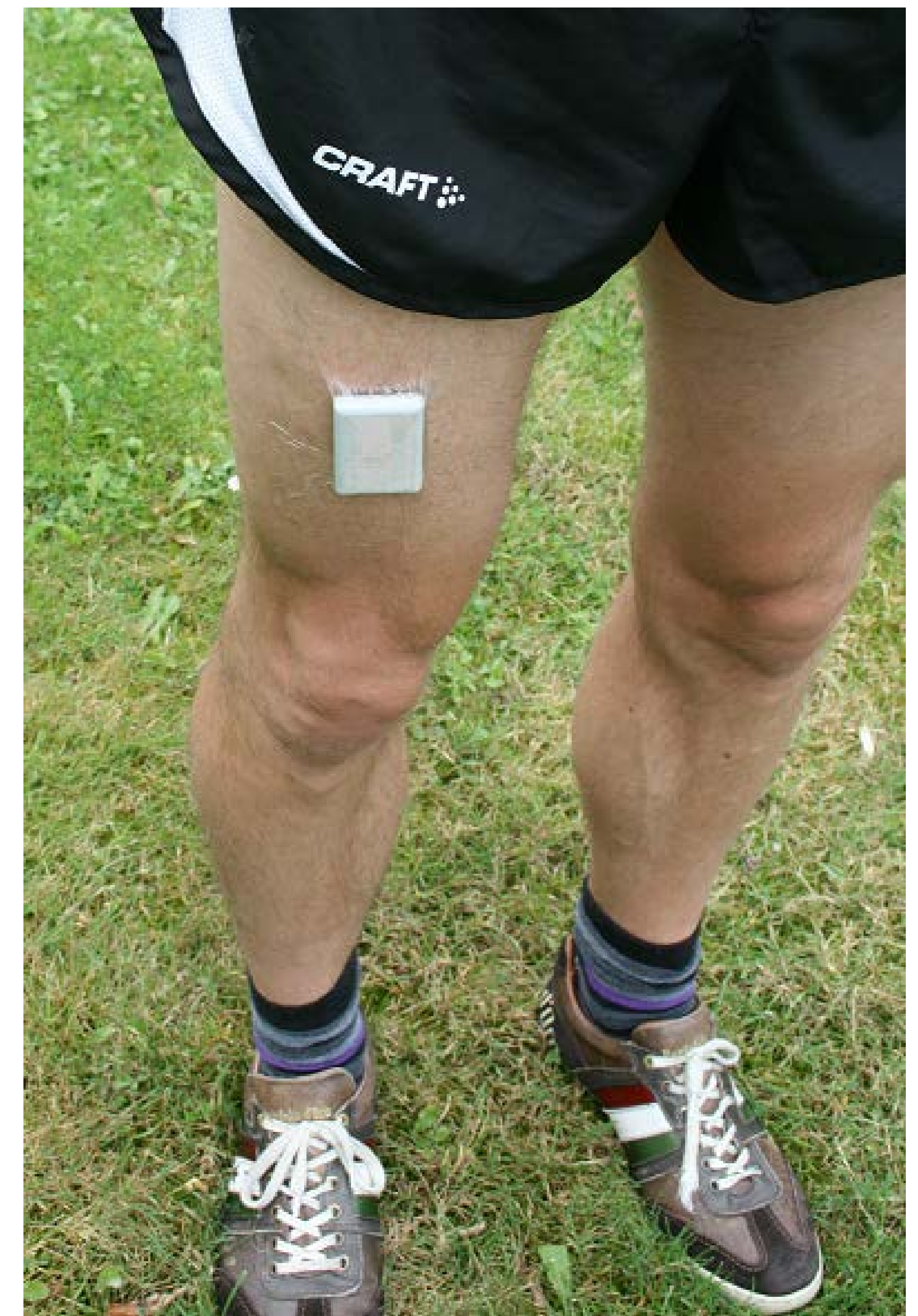
Figuur 1: Fysieke activiteit gemeten met de ActivPAL3™ accelerometer
